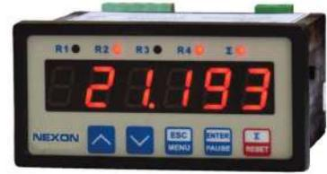
MST200流量控制器与流量传感器一起来测量液体、气体、散物料等介质的瞬时流量并且记录所测介质的累积流量。累积量数值可达16位, 保证长时间对流量值的控制操作。批量操作功能使得MST200可被用于食品、医药、油漆等多种工业场合。继电器输出、增配模拟输出功能: 无隔离型电压输出(0/1...5V,0/2...10V)。此流量控制器可通过面板按键设置或使用S-config组态软件通过RS-485通讯端口设定。
