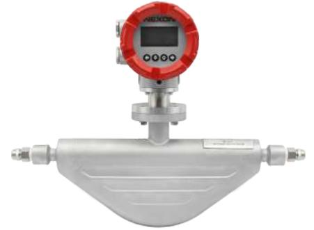
VN系列科氏质量流量计是NEXON新一代微弯型双流量管科氏质量流量计。配有基于数字信号处理（DSP）的电子转换装置，集传感器的数字闭环振动控制（DLC）、信号处理、计算和诊断功能于一身，具有测量精度高、量程比宽、可靠性高的优点。可与手操器通过HART，或与PC通过Modbus通讯，直接对其进行在线节点配置、故障诊断和数据记录。
