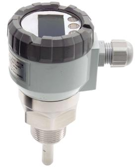
LR3000系列传感器由上向下插入液面，电磁脉冲波被传感器发射出后，沿导杆传导。当其碰到被测介质的液面时，被反射并沿导杆回到传感器。脉冲波的传导时间与其传输距离成正比。由此可以判断出液位的高度。
