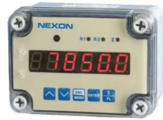
MST100 流量控制器是一款紧凑型的壁挂式控制器。装有电子部分（开路集电极）或接触输入端的MST100可串联流量传感器来获得流量计系数从每升的脉冲数0.01到9999.99。流量控制器可测量液体、气体、散物料等介质的瞬时流量并且记录所测介质的累积流量。宽范围的累积量保证长时间对流量值的控制操作。批量操作功能使得MST100可被用于食品、医药、油漆等多种工业场合。
