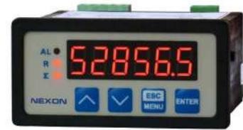
MST300流量控制器与流量传感器一起可获得更宽范围的流量计系数，每升的脉冲数从0.01到9999.99。累积量数值可达15位，保证长时间对流量值的控制操作。
