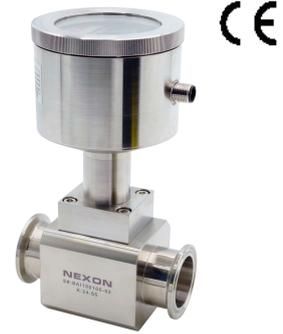
FVX700S涡街流量计原理：流体流过管路时在漩涡发生体的后端产生卡门漩涡，所产生的漩涡数与流量成正比，将其信号取出后就对应于流量。FVX700S是专为食品卫生工业而设计的产品，它可用于气体、蒸汽和液体的测量。流量计的设计没有可动组件，因此故障率很低
